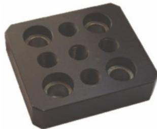
Grundkörper CK45, Werkstückauflage gehärtet und geschliffen. Passbohrungen zum Abstecken in 40er Raster für Nullpunkt. Unterlagen in verschiedenen Auflagehöhen lieferbar.
